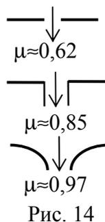
отверстия имеют прямоугольную форму, то  $\mu \approx 0,85$ , а для отверстия с закругленными краями  $\mu \approx 0,97$ .
