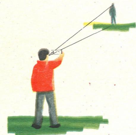
Измерение расстояния до объекта при помощи пластинки Лионде.
