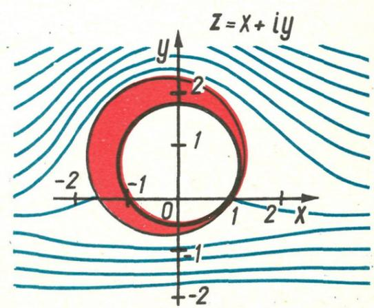
Функция Жуковского от комплексной переменной преобразовывает фигуру профиля, т. е. перпендикулярного сечения крыла самолета, в фигуру, ограниченную двумя окружностями.
