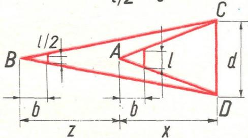
Определение высоты предмета при помощи треугольника.
