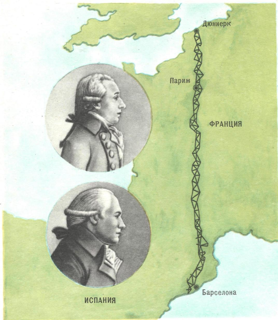
В течение 1792–1799 гг. французские ученые астроном и геодезист Ж. Б. Деламбр (1749–1822) и астроном-гидрограф П. А. Мешен (1744–1804) осуществили градусное измерение дуги меридиана от Дюнкерка до Барселоны (около 1000 км), которое было положено в основу установления метрической системы мер.
