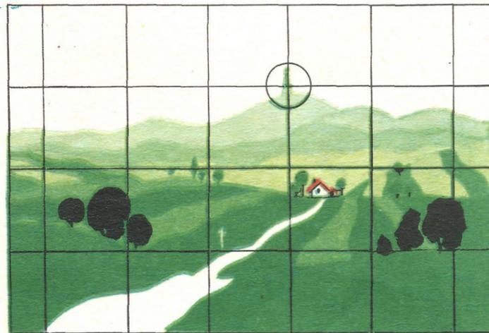
Перспективная съемка с помощью сетки квадратов. На плотном листе бумаги вычертите сетку квадратов, такую же сетку постройте на основе, например, из неорганического стекла. При съемке местности сетка должна располагаться на одном и том же удалении от глаза.
