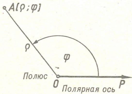
В полярной системе координат положение точки на плоскости задается направлением  $\hat{\varphi}$ , в котором смещается эта точка, и расстоянием  $\rho$  до нее.
