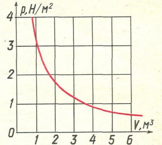
Закон Бойля-Мариотта  $p_1 V_1 = p_2 V_2$  описывает количественную зависимость давления от объема газа. Графиком его является часть дуги одной из веток гиперболы.
