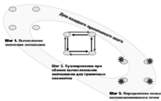
Рис.1 Расчет распространения горящей кромки.
